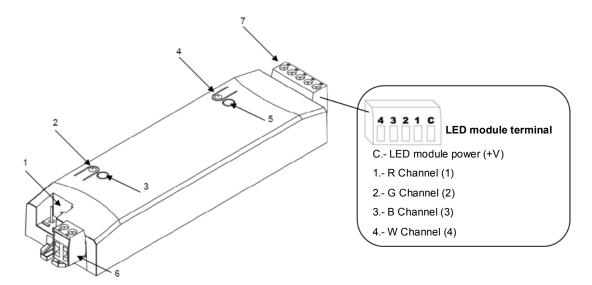
1.- KNX Connector 2.- Programming Button 3.- Programming Indicator 4.- Test Button 5.- Test / Reverse Polarity Indicator 6.- External Voltage Terminal 7.- LED Control Terminal
