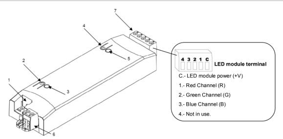
1.- KNX Connector 2.- Programming Button 3.- Programming Indicator 4.- Test Button 5.- Test / Reverse Polarity Indicator 6.- External Voltage Terminal 7.- LED Control Terminal
